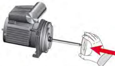
2. Для каждой ступени последовательно установить направляющее колесо 171, рабочее колесо 230 и ступенчатый корпус 109.
