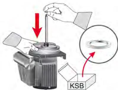
13. Установить на вал стопорное кольцо 932.03 торцевого уплотнения.
