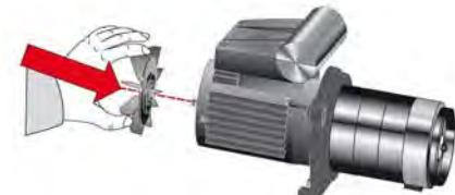
6. Установить кожух вентилятора 832 на корпус двигателя.
