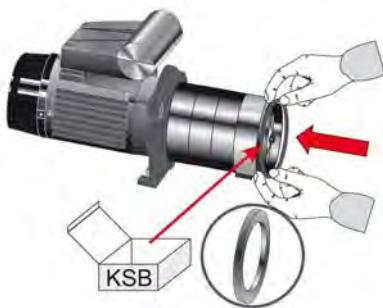
4. Наложить подкладную шайбу 554.02, завернуть две гайки 921 и затянуть их.
