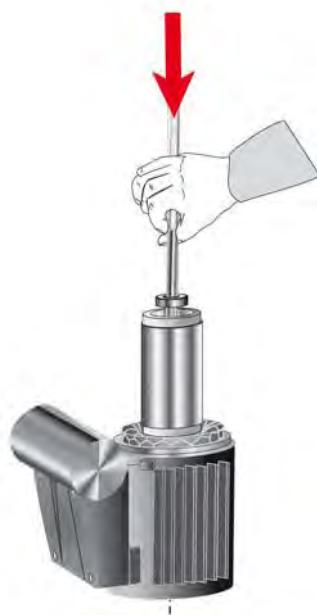
6. Установить неподвижную часть торцевого уплотнения 433, следя за правильной посадкой.
