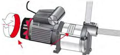
3. При неправильном направлении вращения проверить электроподключение двигателя и при необходимости распределительное устройство.
