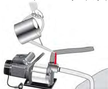
3. Ввинтить пробку наливного отверстия с моментом не более 10 Нм.
