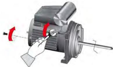
4. Снять напорную крышку.
