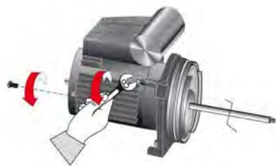
10. Смочить вал мыльной водой для облегчения монтажа вращающейся части торцевого уплотнения 433.
