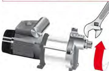
5. Надеть всасывающий трубопровод на штуцер и зажать хомутом.
