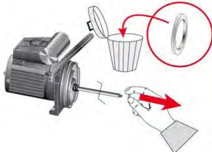
2. Снять и отправить на утилизацию вращающуюся часть торцевого уплотнения 433.
