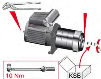
5. Надеть крыльчатку 831 на вал двигателя.
