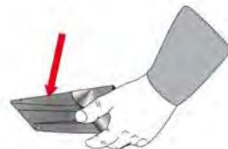
5. Проверить, правильно ли установлено уплотнение крышки клеммной коробки.
