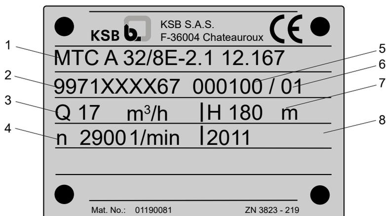
Рис. 5: Заводская табличка (пример) Multitec
